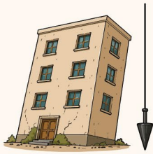
inclinación o desplazamiento evidente de la estructura,
