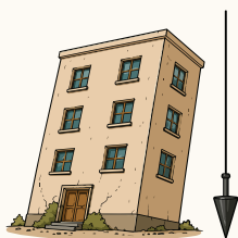
inclinação ou deslocamento evidente da estrutura,
